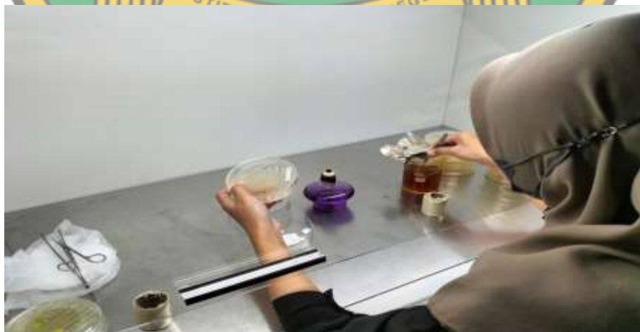
Gambar 3. Proses pencelupan kertas saring kedalam larutan HCN
