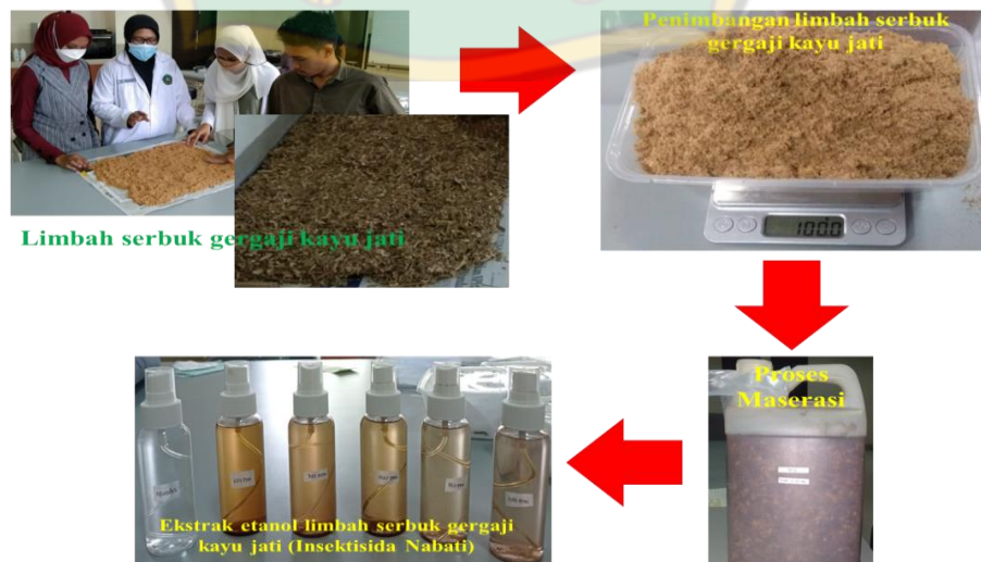
Gambar 4.2 Tahapan umum proses pembuatan ekstrak etanol limbah serbuk gergaji kayu jati
