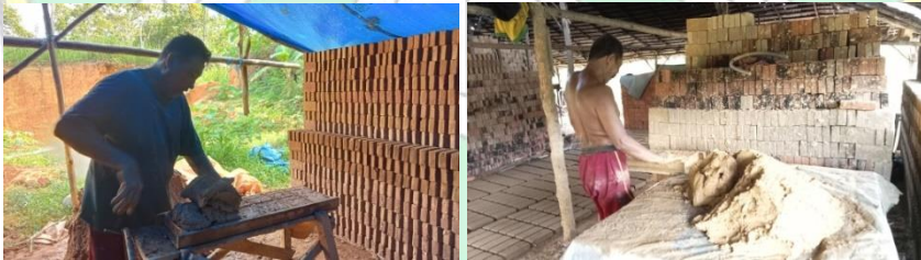
Gambar 4.2 Proses Pencetakan Batu Bata
